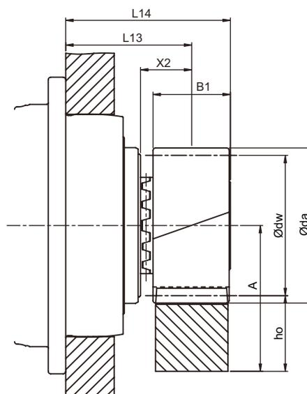
Tooth Thickness Tolerance : e24
